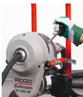
Zatažení páky spojky roztočí spirálu
