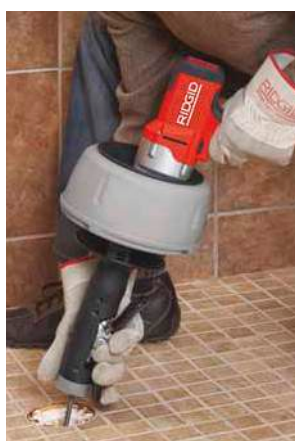
Spirála \frac{3}{8} " (10 mm) u modelu K-45AF-5 rozšiřuje možnosti použití čističky i na odpadní potrubí 2\frac{1}{2} " (75 mm)
