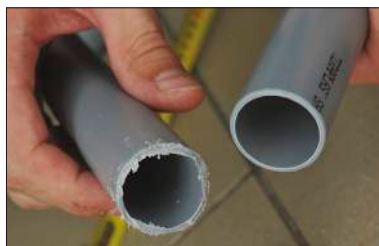
Řez pilkou na kov (vlevo) oproti P-Tec 3240 (vpravo).
