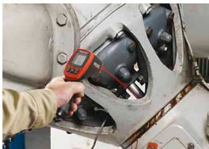
Teplotní diagnostika opotřebitelných součástí pro preventivní údržbu zařízení
