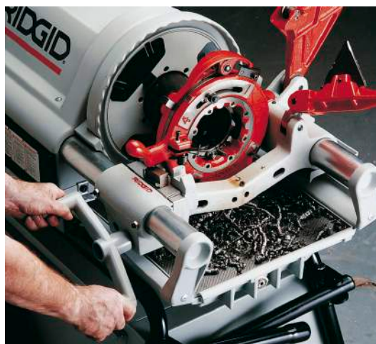
Závitořezná hlava, model 714 (914) v provedení s oddalováním.
