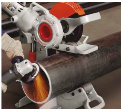
Model 258 s otáčecím zařízením při vytváření úkosu. Pro tuto práci se doporučuje práce ve dvojici
