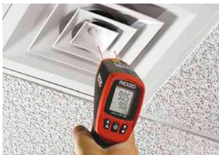
Měření úrovně odvádění tepla pro odhalení a lokalizaci tepelných ztrát v průtokových systémech
