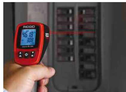
Kontrola přehřívání pojistek nebo jističů, což může být způsobeno přetížením obvodů
