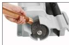
Volitelný brusný disk se používá k obroušení vnější plochy při příliš těsném lícování
