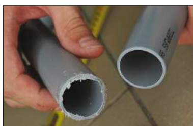
Řez pilkou na kov (vlevo) oproti P-Tec 3240 (vpravo).
