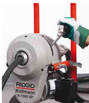
Zatažení páky spojky roztočí spirálu
