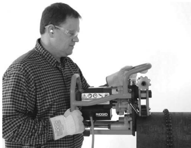
Obrázok 8A – Umiestnenie úkosovačky na rúru
