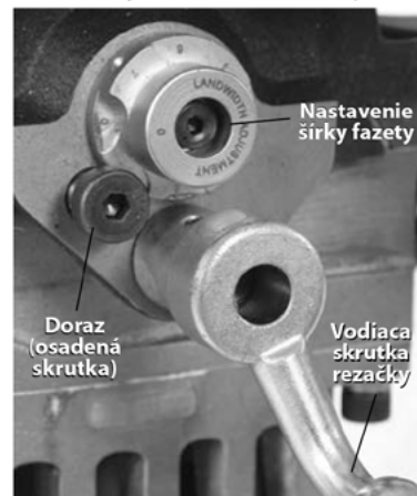
Obrázok 12 – Nastavenie nastavovacej šablóny pre šírku fazety
