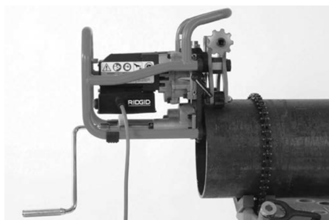
Obrázok 11 – Úkosovačka upevnená na obrobnku
