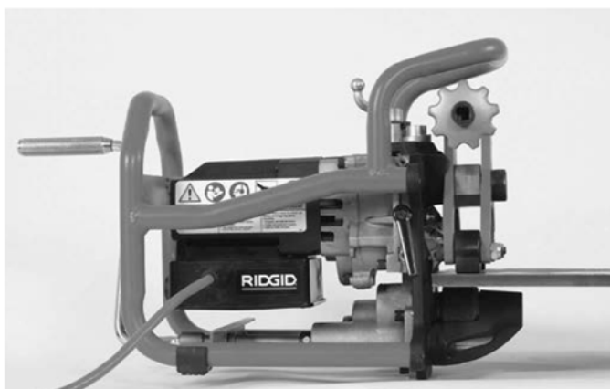
Obrázok 9B – Inštalácia úkosovačky na plechu
