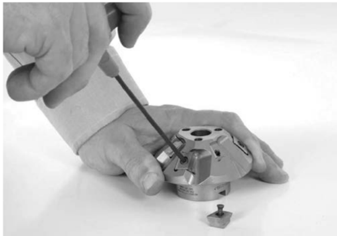
Obrázok 18 – Výmena rezných vložiek
