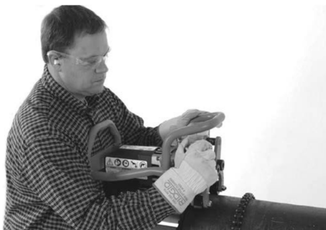
Obrázok 10A – Ručne utiahnite sťahovaciu skrutku
