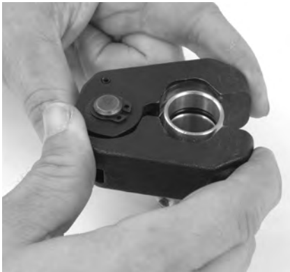
Figura 9 – Montaje del aro sellador en el acoplamiento
