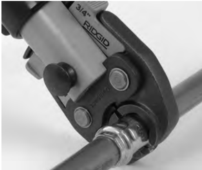
Figura 7 – Colocación de la mordaza tipo tijera para que encierre el acoplamiento
